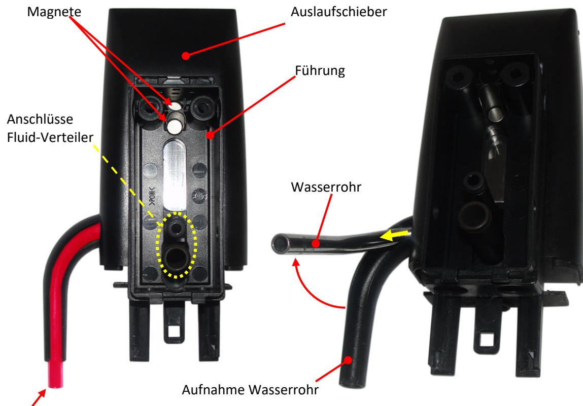
10. Das Wasserrohr (eingefärbt) vorsichtig zur offenen Seite hin aus der Aufnahme drücken, dann mit Gefühl nach oben schwenken und dabei aus dem Auslaufschieber ziehen (gelber Pfeil). Weiter geht's auf der anderen Seite (Schiebervorderseite).
