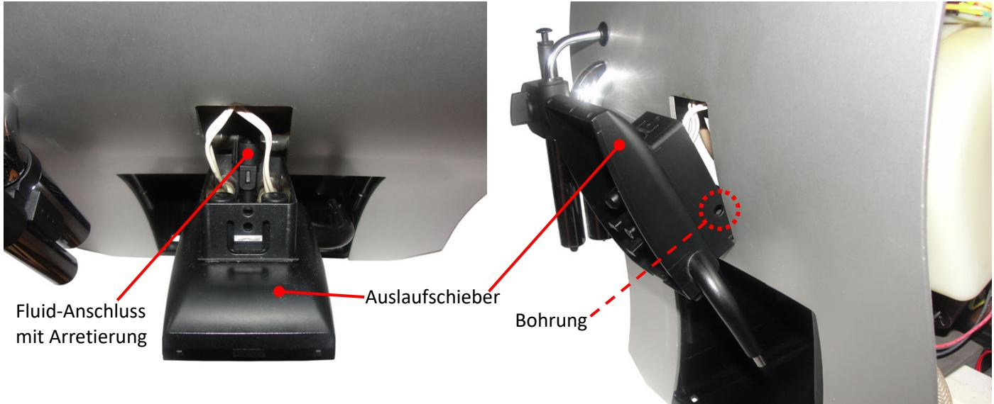
8. Den Fluid-Verteiler vom Fluid-Anschluss trennen, hierzu den Auslaufschieber auf der Oberseite soweit herausziehen/-schwenken, bis die seitliche Bohrung freigegeben wird. Über diese Öffnung kann die entsprechende Arretierung mit einem geeigneten Werkzeug entriegelt werden. Wie, bzw. wie man sich z.B. leicht ein entsprechendes "Spezialwerkzeug" aus einem Nagel bauen kann, zeigen wir nachfolgend.
