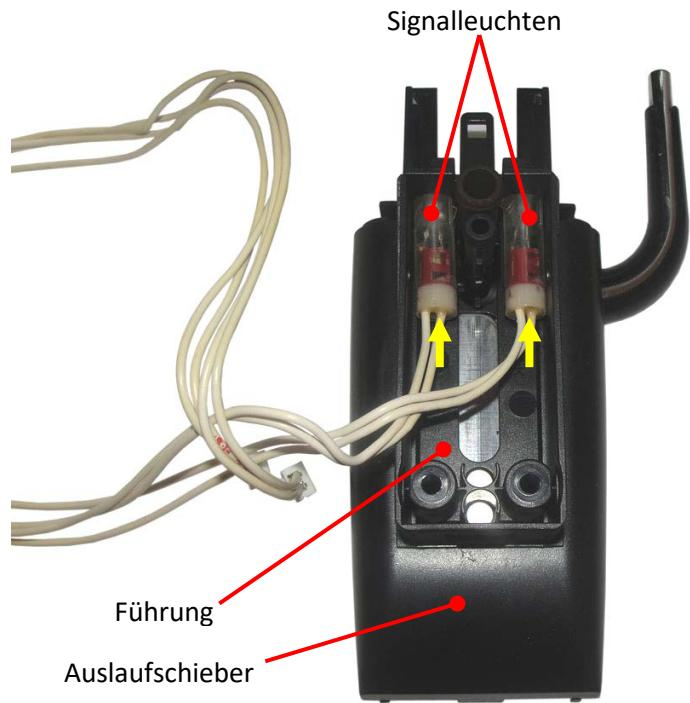
9. Die zuvor gelösten Kabel der Tassenbeleuchtung vorsichtig aus dem Gehäuse ziehen, die beiden Signalleuchten von innen nach außen (gelbe Pfeile) aus der Auslaufführung drücken und die Kabel durchziehen.
