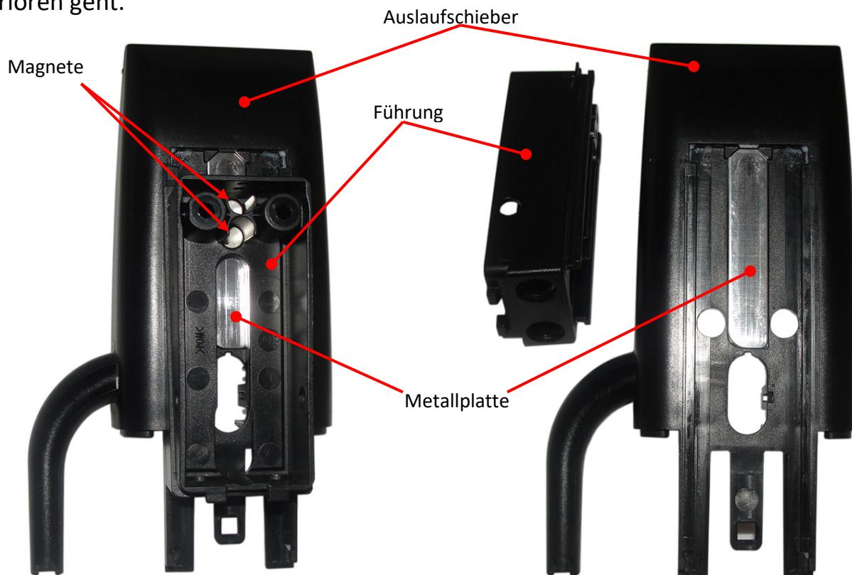
12. Jetzt noch die Auslaufführung nach unten abziehen und die Metallplatte herausnehmen/-kippen, dann kann der Auslaufschieber ausgetauscht werden. Sollte die Auslaufführung ebenfalls ausgetauscht werden, müssen zuvor noch die beiden Magnete entfernt werden.
