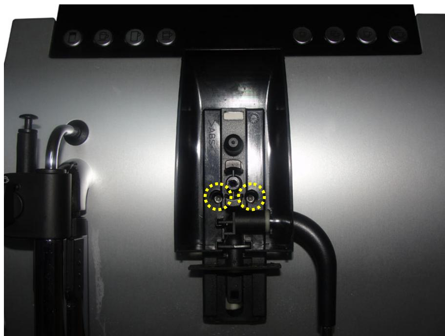
5. Wenn sich der Auslaufschieber ganz oben befindet, sind die beiden gelb eingekreisten Befestigungsschrauben zugänglich, diese herausdrehen und den Schieber wieder ganz nach unten schieben.
