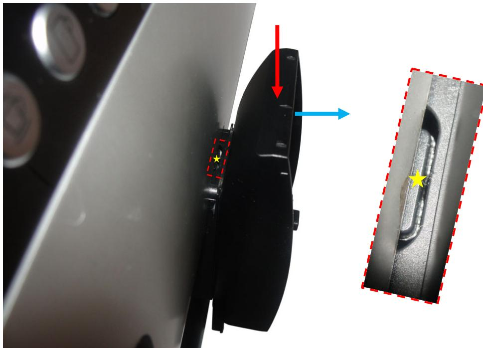
6. Gemäß dem roten Pfeil leicht auf den Schieber drücken und die Oberseite dabei aus dem Gehäuse ziehen (blauer Pfeil), sollte sich die Arretierung dadurch nicht lösen lassen, ggf. mit einer Messerklinge auf die Arretierzunge (gelber Stern) drücken und diese dadurch entriegeln. Bevor der Auslaufschieber weiter ausgebaut wird, auf ....
