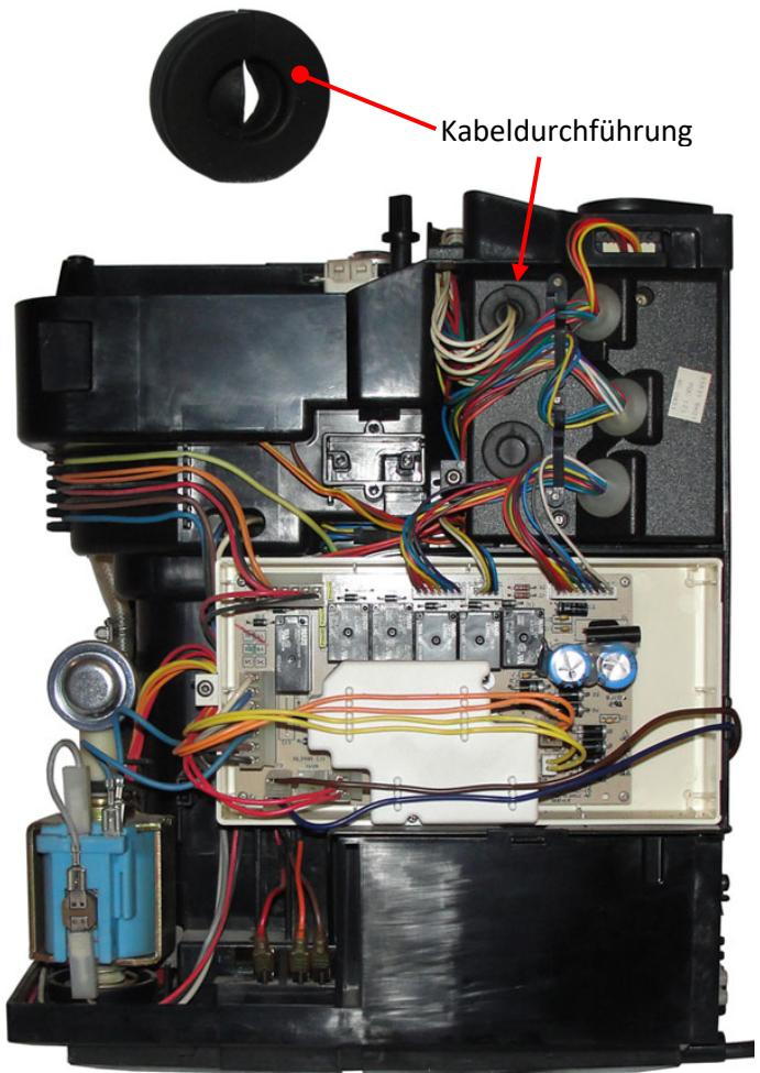
7. .... der Geräteoberseite die gelb eingekreiste Schraube herausdrehen, die Kabelkanalabdeckung abnehmen und den Niederhalter nach oben herausziehen. Auf der Geräterückseite die obere linke Kabeldurchführung herausziehen, die beiden elektrischen Steckverbindungen von der Platine abziehen und die zugehörigen Kabel aus dem Kabelkanal nehmen.
