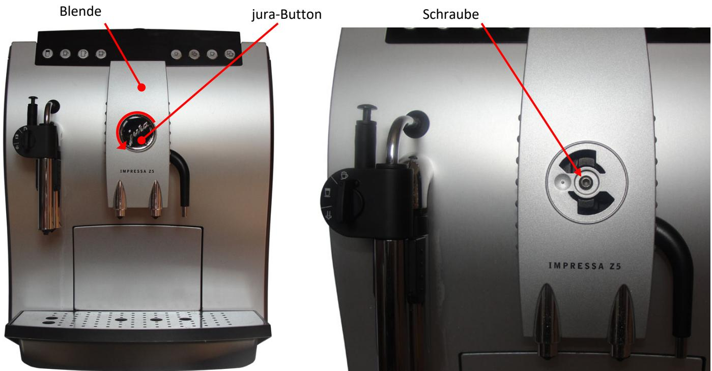
1. Wenn lediglich der Auslauf ausgetauscht werden soll, einfach den "jura"-Button bis zum Anschlag (ca. 45°) entgegen dem Uhrzeigersinn drehen, ggf. zum Drehen ein Stück Antirutschmatte verwenden. Den Button abnehmen und die darunterliegende Schraube herausdrehen. Sofern nicht bereits geschehen den Auslaufschieber ganz nach unten schieben.
