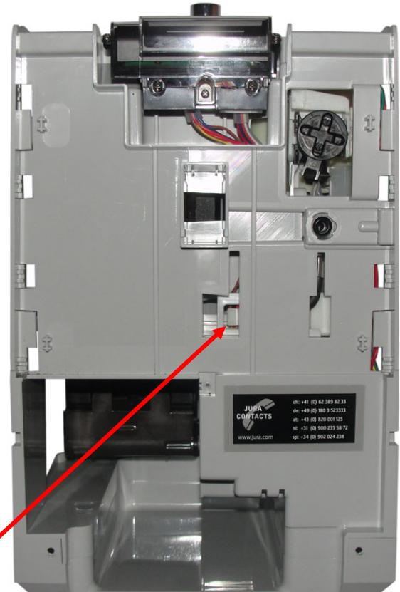
5. Um den Kabelhalter Rotary herausziehen zu können, muss auf der Gehäusevorderseite gegen die Verriegelung gedrückt werden. Die Rotarybox kann dann nach oben hin aus dem Gehäuse genommen bzw. gezogen werden. Beim herausziehen des Kabelhalters sowie der Rotarybox natürlich auf die umliegenden Kabel und den Schlauch achten.
