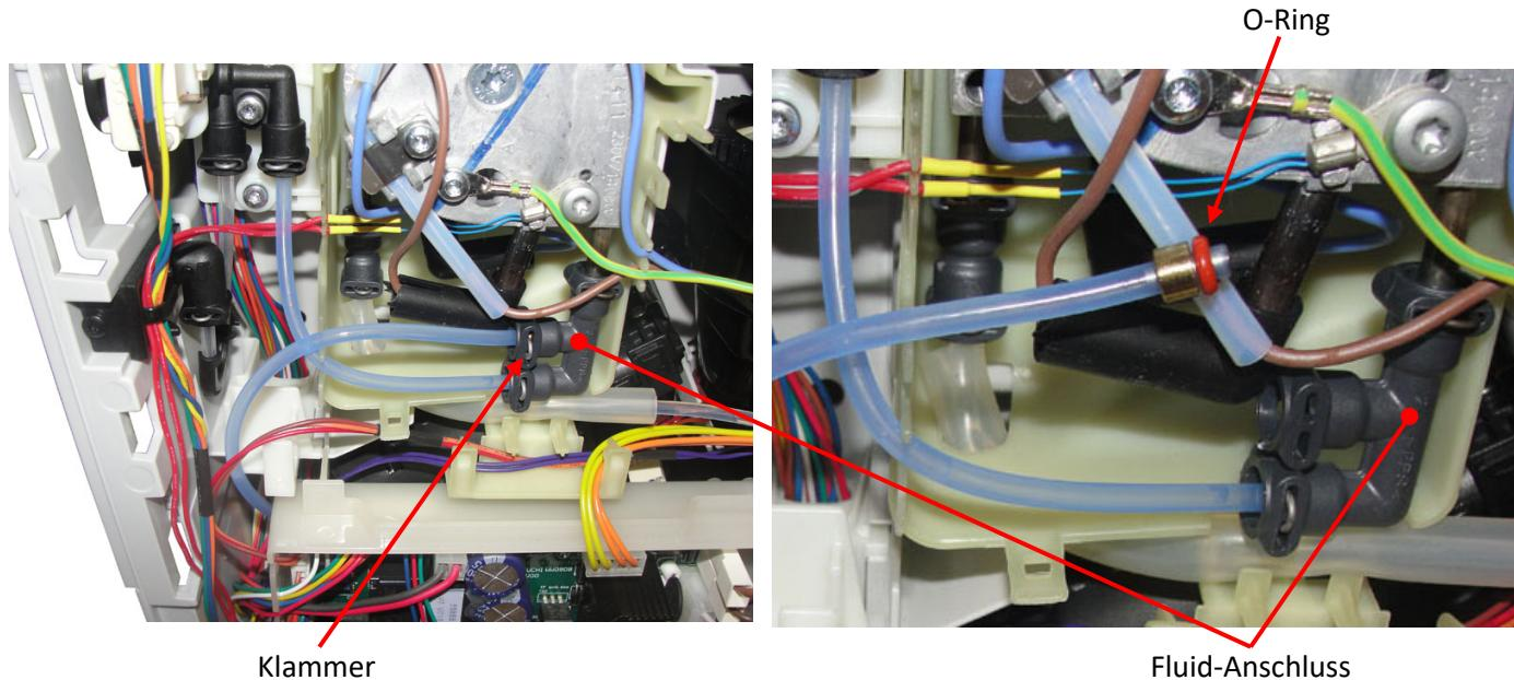
3. Die obere Klammer aus dem Fluid-Anschluss ziehen und dann den Schlauch aus dem Anschluss. Auf der Schlauchspitze kann sich ein O-Ring befinden, wenn nicht, steckt er noch im Anschluss und sollte verzugsweise entfernt werden, hierzu ggf. eine Büroklammer zu einem kleinen Haken biegen.
