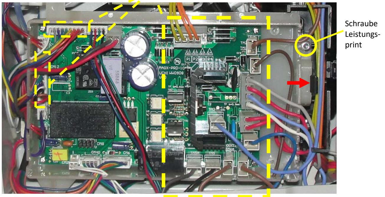
4. Die Schraube vom Leistungsprint herausdrehen. Die Steckverbindungen der rechten Printhalbseite sowie die großen 9- und 12-poligen Rotarybox-Steckverbindungen auf der linken Seite abziehen (gelb eingerahmt) und die Kabel aus den Führungen nehmen. Das Leistungsprint ist linksseitig gelagert, die rechte Seite kann daher nun aus dem Gehäuse geschwenkt werden (zu Entriegeln den kleinen Hebel drücken (roter Pfeil)) damit auf der linken Seite der Kabelhalter Rotary freigegeben wird.
