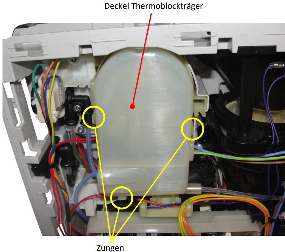
2. Die linke und die rechte Zunge vom Thermoblockträger leicht nach außen drücken und den Deckel abziehen. Die untere Zunge kann im Normalfall vernachlässigt werden, sie kann ggf. aber auch leicht nach unten gedrückt werden.
