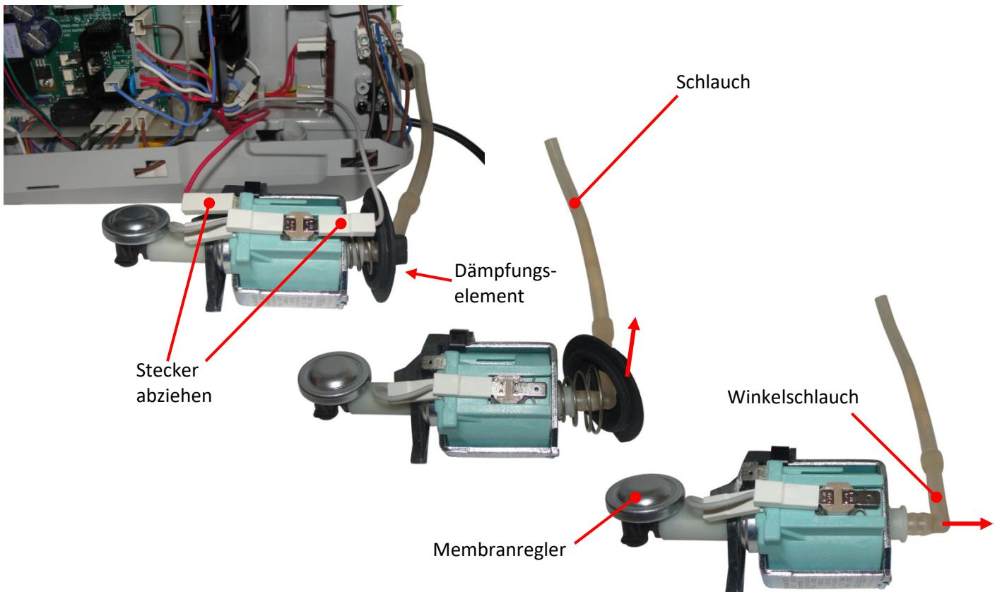
6. Die beiden aus dem Gehäuse kommenden Kabel/Stecker von der Pumpe bzw. vom Thermostat abziehen und das Dämpfungselement vom Schlauch abnehmen. Dann den Winkelschlauch von der Pumpe abziehen und den Memranregler abschrauben.
