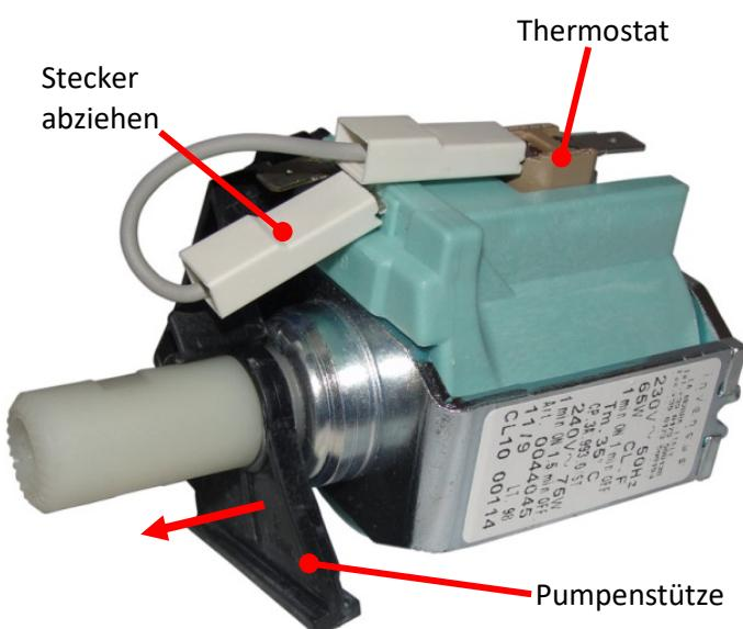
8. Das vom Thermostat kommende Kabel und die Pumpenstütze von der Pumpe abziehen.
