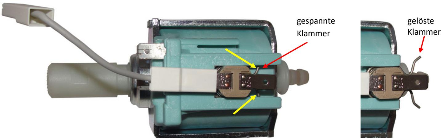
9. Zum Ausbau des Thermostats die beiden Klammerenden gemäß den gelben Pfeilen, abwechselnd mit einem Schraubendreher, schräg nach rechts heraushebeln/-drücken (die Klammerenden jeweils etwas weg von der Wandung, in Richtung Ausgang, drücken). Die Pumpe kann nun ausgetauscht werden.
