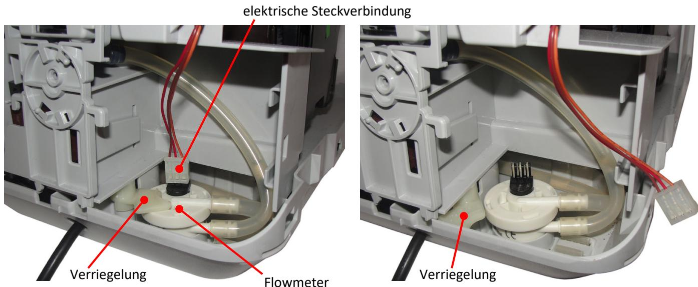
2. Zuerst auf der linken hinteren Gehäuseseite die elektrische Steckverbindung vom Flowmeter abziehen, dann die Verriegelung etwas anheben und im Uhrzeigersinn drehen. Der Flowmeter kann nun nach oben hin aus der Aufnahme genommen werden.
