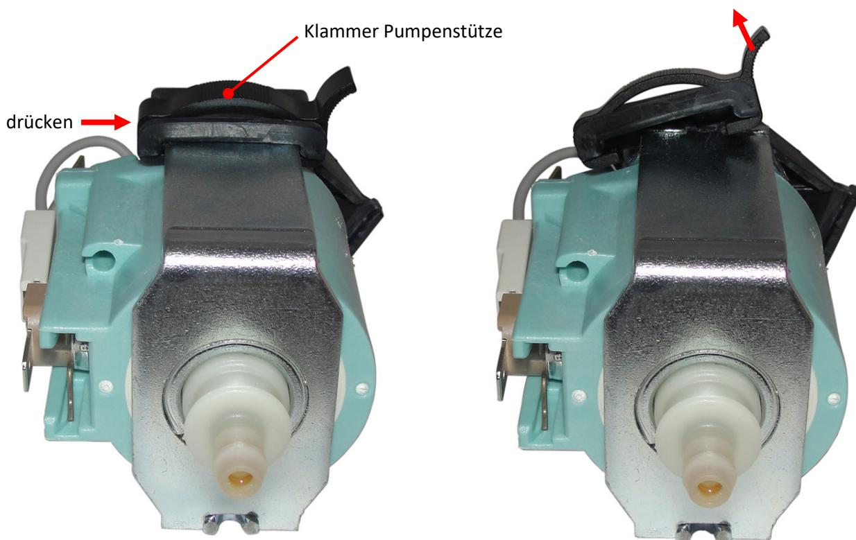
7. Seitlich gegen die Klammer der Pumpenstütze drücken und auf der gegenüberliegenden Seite den Hebel nach oben ziehen/drücken. Die Pumpenstützenklammer dann vom Metallbügel der Pumpe abnehmen.
