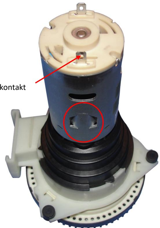
Die Anschlüsse der neuen Motoren sind meistens nicht mehr mit Plus und Minus gekennzeichnet, in der Regel sollte aber nachfolgender Tipp passen:
